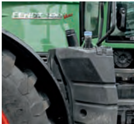
Новичок распознается по наличию второго бака с голубой крышкой для раствора мочевины AdBlue с левой стороны трактора...
