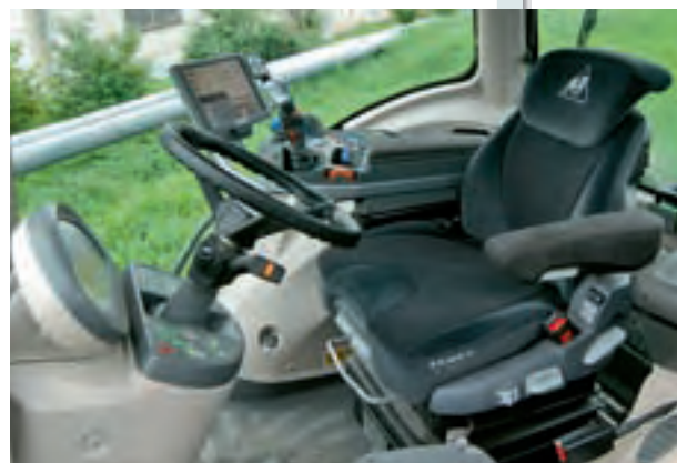
В кабине тоже внешне мало что изменилось. Измененный сброс избыточного давления позволяет теперь легче закрывать двери.
