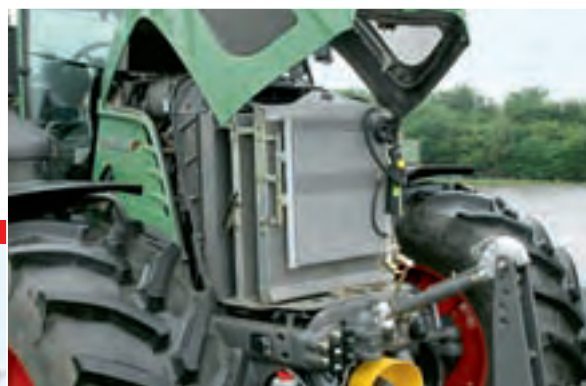
Двигатель Deutz TCD 2013 вместо почти 7,2 л имеет теперь объем двигателя 7,8 л и катализатор SCR, соответствующий нормам токсичности III В.
