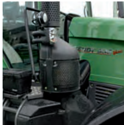
...и большой „кастрюле“ по правую сторону, скрывающей в себе катализатор.
